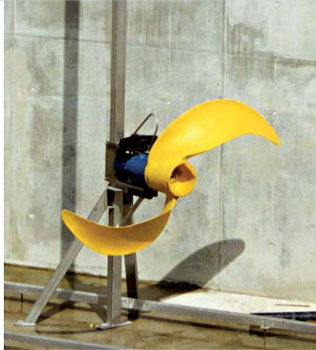
Bild 4.10: Langsam laufendes Rührwerk
